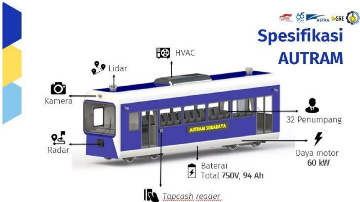
Lebih lanjut, Inung juga menerangkan bagaimana sistem penggerak pada AUTRAM dijalankan. Tidak seperti trem pada umumnya yang menggunakan tenaga listrik, AUTRAM bergerak dengan baterai bertenaga surya. “Jika daya pada baterai habis, maka akan diganti dengan baterai baru yang telah dicas di stasiun pengecasan,” tutur pemuda asal Jember ini.
